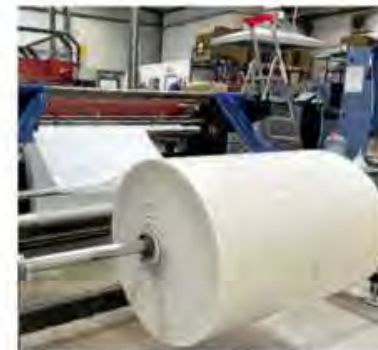
Die Folien bestehen aus Polyethylen (PE). Ihr Recycling-Anteil ist sehr hoch.
